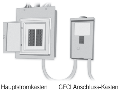
Hauptstromkasten GFCI Anschluss-Kasten
